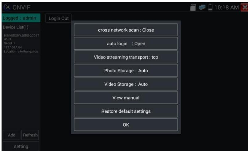
**Across network segments scan** (сканирование сетевых сегментов): после открытия этой функции введите "Setting"- "IP Settings"- "Advanced" («Настройки» - «Настройки IP» - «Дополнительно»), чтобы добавить к сканированию другие сегменты сети.
