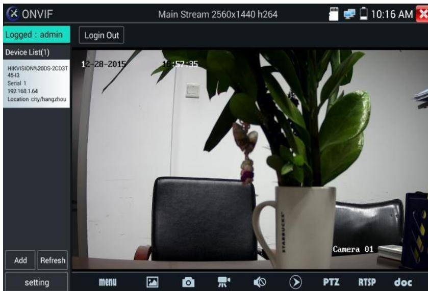
**Снимок:** нажмите “Snapshot” («снимок»), чтобы получить скриншот изображения и сохранить его на SD-карте. Если выбрано сохранение вручную, появляется диалоговое окно «Input Name», определяемое пользователем имя файла для сохранения на SD-карте, если выбрать «Автосохранение», тестер автоматически сохраняет файлы после моментального снимка.
