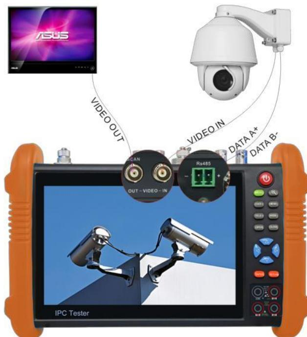
Камера (видеовыход другого устройства) подключается к разъёму «VIDEO IN» тестера. После нажатия кнопки PTZ, на дисплее тестера должно появиться изображение.
