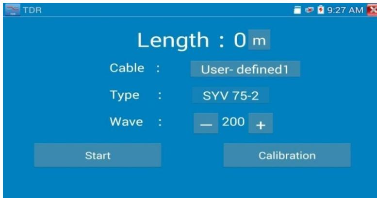
1. Выберите пользовательский тип кабеля и нажмите «Калибровка», чтобы начать тест, нажатие «user defined 1» позволяет ввести имя кабеля, например: AiPu BNC-5.
