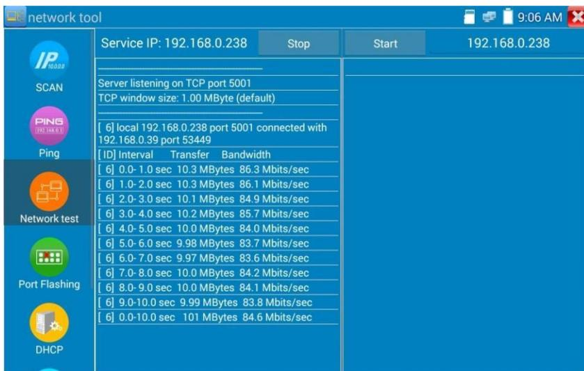
Пропускную способность сети также можно протестировать с помощью компьютера, использующего совместимое программное обеспечение для тестирования пропускной способности сети. Установите программное обеспечение для тестирования пропускной способности сети на компьютере, в качестве тестового клиента или сервера, для проведения взаимных испытаний с помощью тестера. Если компьютер используется как сервер, IP-адрес компьютера должен быть : 192.168.0.39
