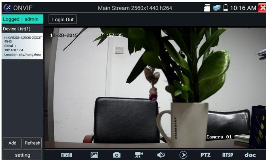
В левой части экрана будут перечислены все найденные камеры ( имя камеры и IP-адрес). Тестер может автоматически подключиться к камере и отображать изображение поступающее с камеры. По умолчанию используется пароль администратора для автоматического входа в систему, если вы уже изменили пароль, то он по умолчанию будет использован для входа в систему.
