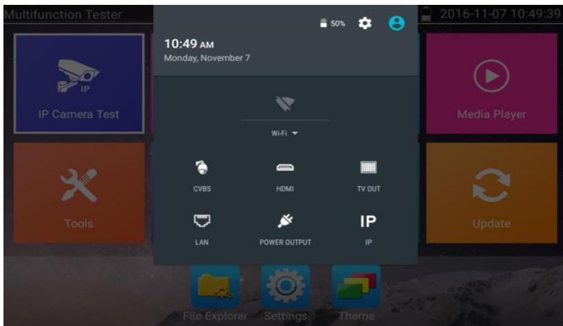
**HDMI:** Нажмите «HDMI IN» для входа. В режиме HDMI IN можно конвертировать тестовый сигнал с аналогового на цифровой с двойным тестовым окном IP & HDMIN или аналоговым и HDMI входом.
