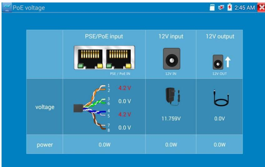
Подключите сетевой кабель от коммутатора PoE к порту PSE IN IP-тестера. Подключите IP-камеру или другую технику, питающуюся от PoE, используя порт LAN, на экране отобразится напряжение PoE и состояние соединения контактов кабеля.
