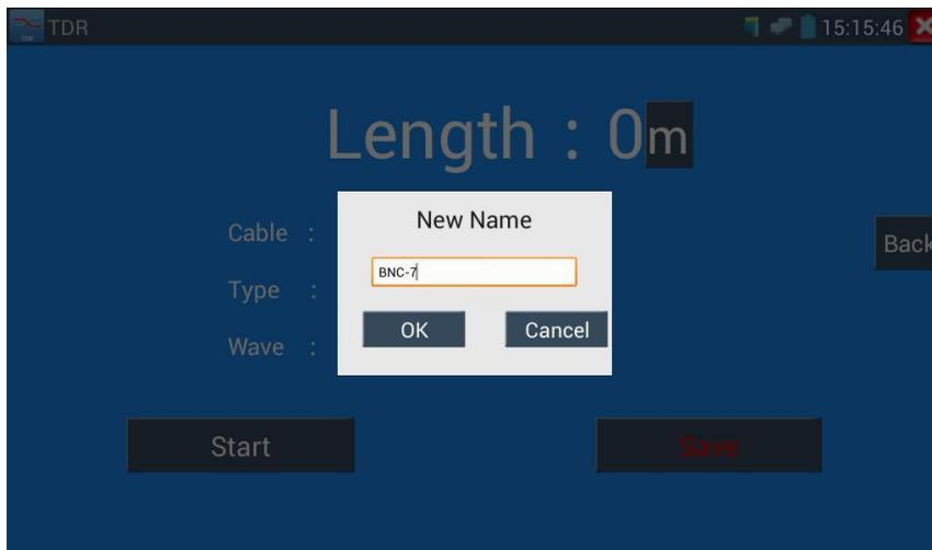
**Применение:** Тест TDR - это метод импульсного отражения, передающий импульсный сигнал по тестируемому кабелю. Когда кабель разомкнут или замкнут, генерируется отраженный импульс, тестер принимает и обрабатывает отраженную волну, результаты измерений отображаются на экране. TDR может проверить обрыв цепи и короткое замыкание кабеля, помочь специалисту быстро найти местоположение кабельной проблемы. С его помощью можно удобнее и эффективнее отремонтировать неисправный кабель.
