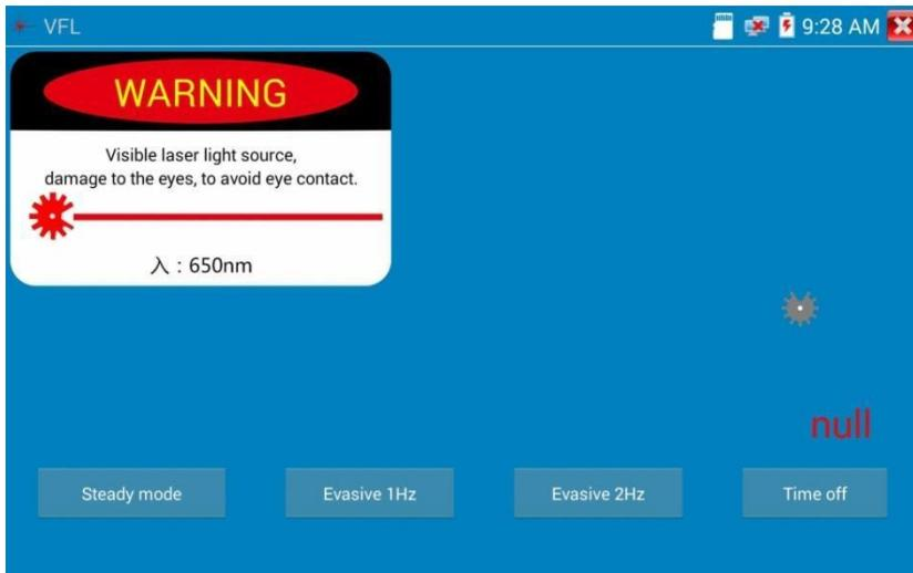
VFL может выбрать четыре режима: Steady Mode, «Evasive 1 Гц», «Evasive 1 Гц» и «Steady Mode». Нажмите кнопку «Steady Mode», чтобы войти в режим постоянного сигнала, нажмите кнопку «Evasive 1 Гц» и «Evasive 2 Гц», чтобы войти в режим импульсов, нажмите кнопку «Time Off» для задания интервала времени. Можно выбрать интервал (5 минут, 10 минут, 30 минут, 60 минут и 120 минут).
