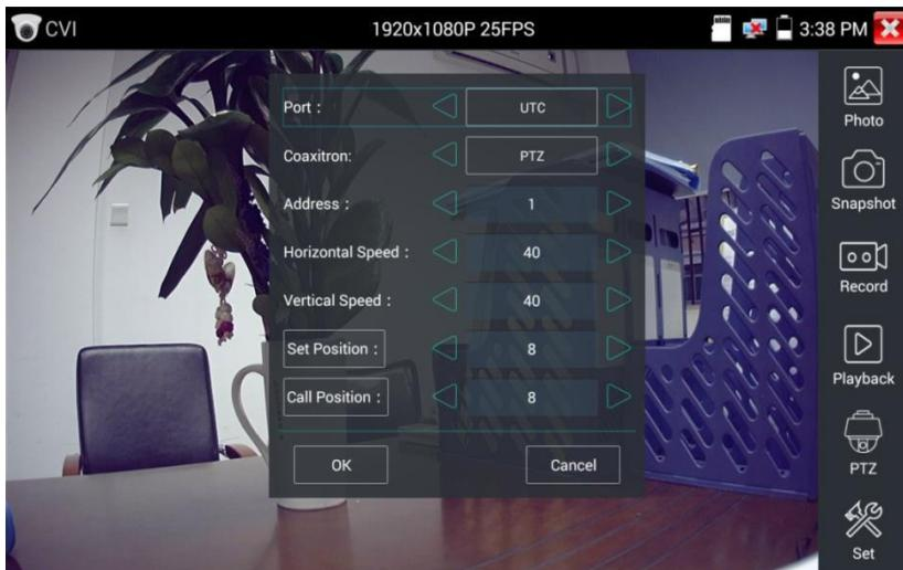
Адрес PTZ в тестере должен быть такой же, как и на камере. После установки этого параметра тестер может управлять PTZ и объективом.
