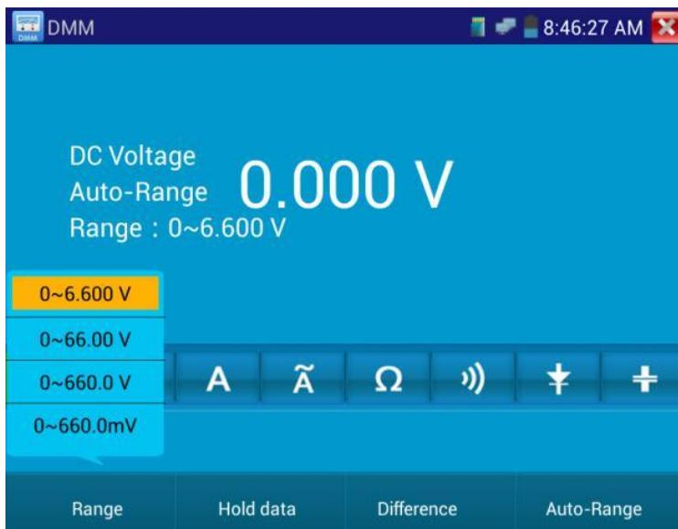
При работе с тестером нажмите “Range select” для выбора диапазона вручную, нажмите “Auto range” для входа в режим автоматического выбора пределов измерений.
