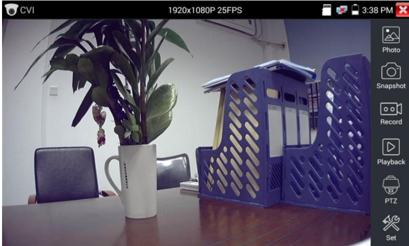
При вводе сигнала HD CVI тестер отображает разрешение изображения на верхней панели. Дважды нажмите на экране, чтобы изображение отображалось в полноэкранном режиме.
