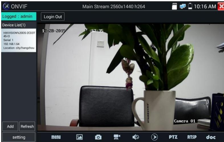
**Управление ONVIF PTZ:** коснитесь изображения в том направлении, в котором вы хотите, чтобы камера PTZ двигалась.
